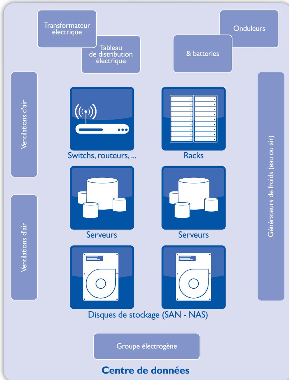
**Figure 5 :** Schéma générique des composants d'un centre de données
